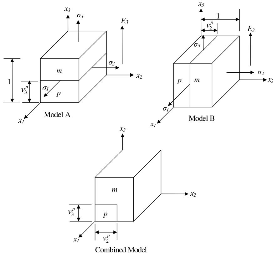
**Figure 2.** RVEs for isofield model ( $p$ : piezoceramic,  $m$ : matrix).
